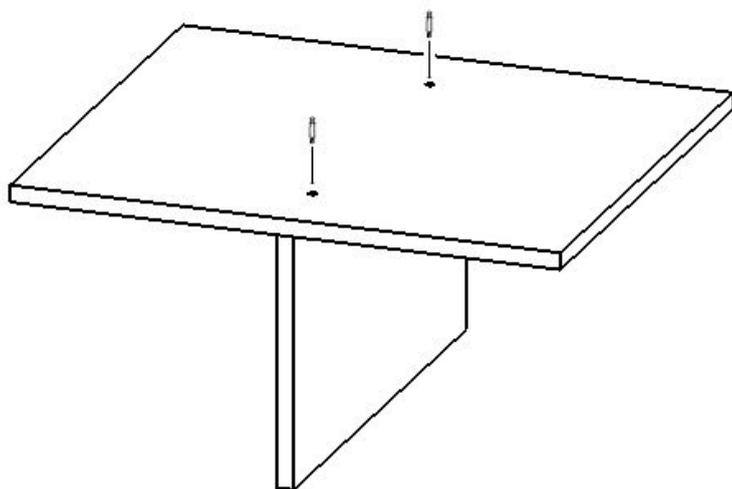
2. Вставить полкодержатели в отверстия боковых стенок корпуса шкафа, установить на них Т-образную полку
