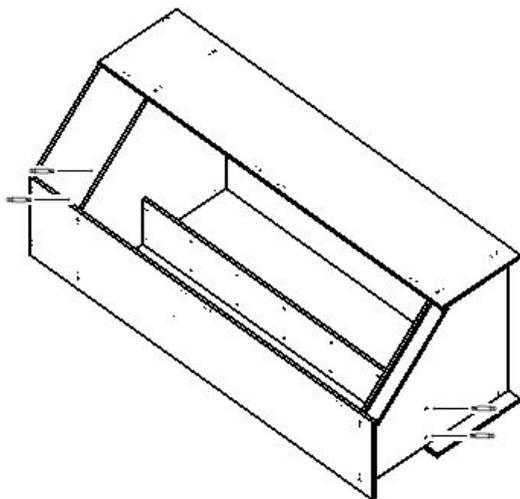
9. Установить деталь арт. 01.02.01 с помощью гвоздей, в торец детали арт. 01.02.01 вставить профиль соединительный (2 части)
