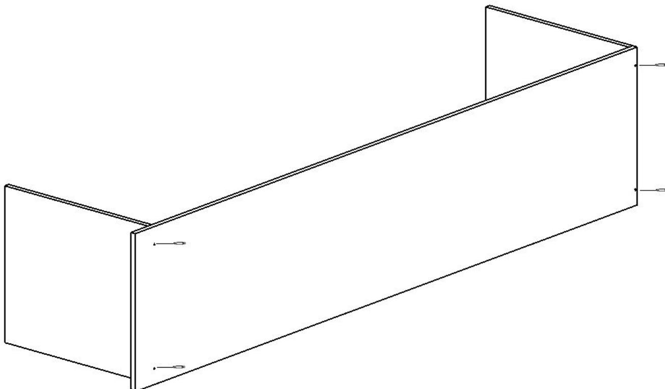
3. Установить две цокольные планки арт. 01.01.05. Первая планка: от переднего края шкафа отмерить 20 мм, приставить цокольную планку и закрепить мебельными уголками изнутри с помощью саморезов. Вторая планка: от заднего края шкафа отмерить 50 мм, приставить цокольную планку и закрепить мебельными уголками изнутри с помощью саморезов.
