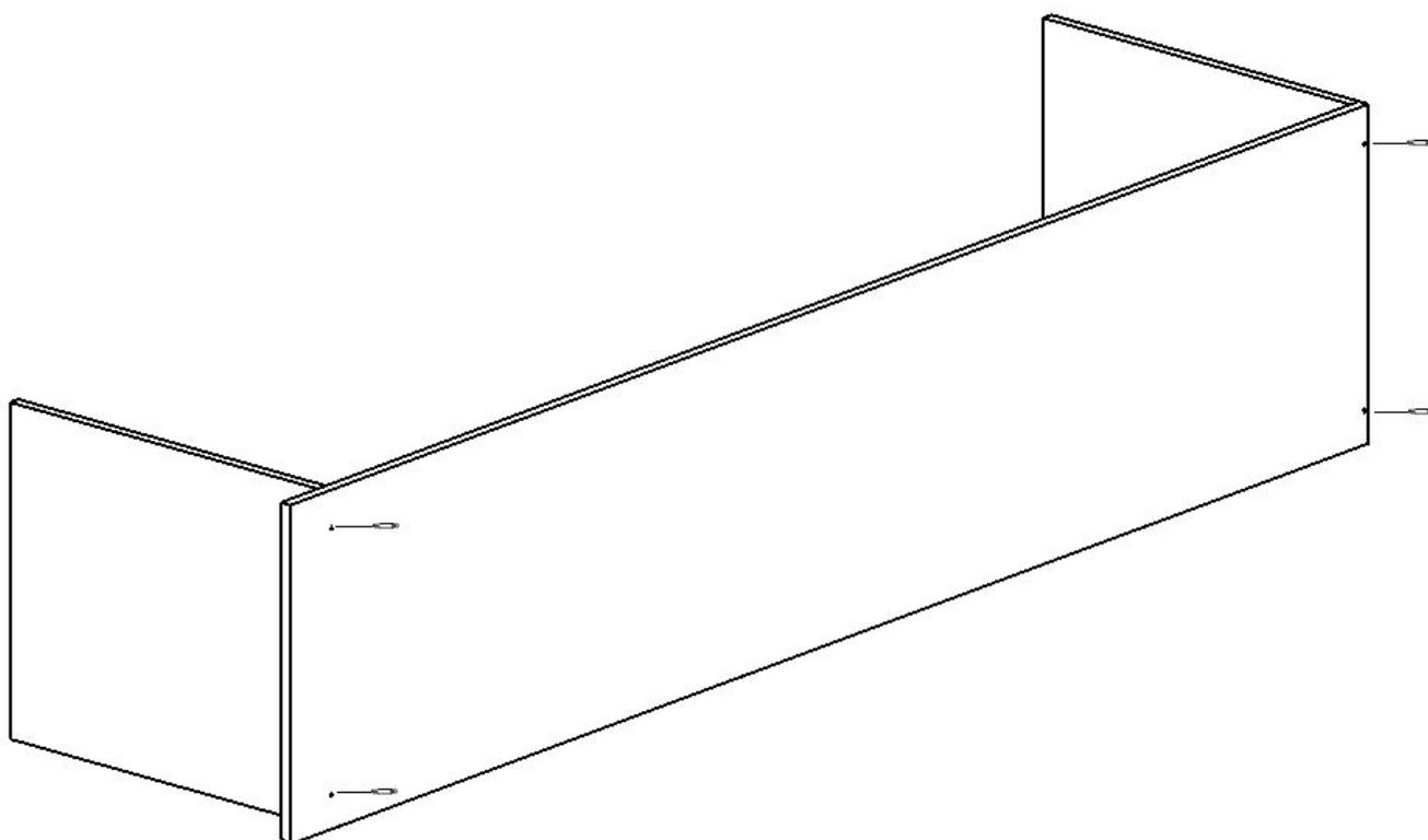
3. Установить две цокольные планки арт. 01.04.05. Первая планка: от переднего края стеллажа отмерить 20 мм, приставить цокольную планку и закрепить мебельными уголками изнутри с помощью саморезов. Вторая планка: от заднего края стеллажа отмерить 50 мм, приставить цокольную планку и закрепить мебельными уголками изнутри с помощью саморезов.
