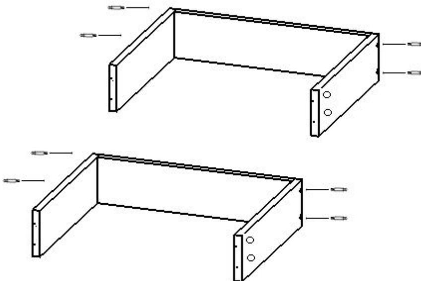
6. Присоединить деталь арт. 03.04.05, закрутить эксцентрики минификсов
