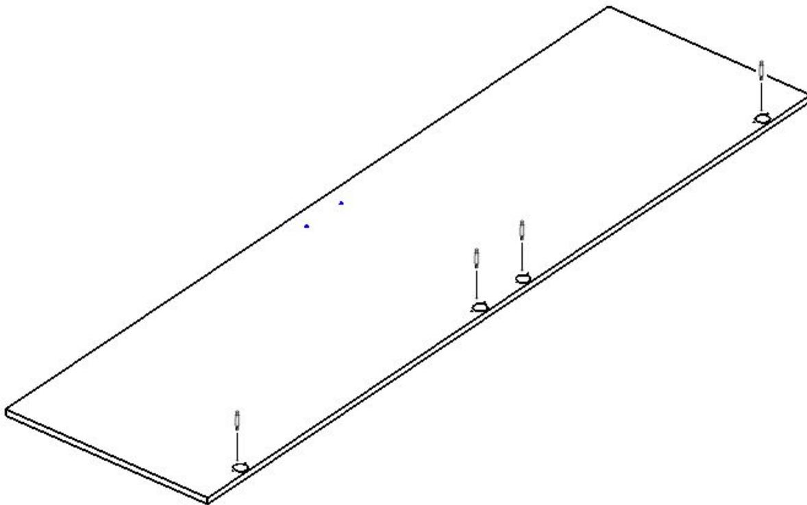
2. К боковине корпуса шкафа арт. 01.01.02 или арт. 01.01.03 прикрутить с помощью саморезов ответные планки петель
