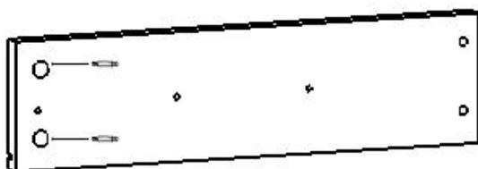
2. В указанные отверстия деталей арт. 03.03.02 и арт. 03.03.04 с помощью шурупов установить направляющие
