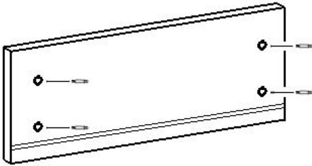
5. Присоединить деталь арт. 03.03.05, закрутить эксцентрики минификсов
