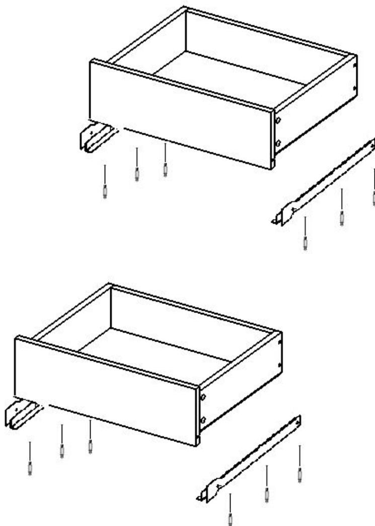
9. В указанные отверстия деталей арт. 03.04.07 и арт. 03.03.08 вставить эксцентрики минификсов
