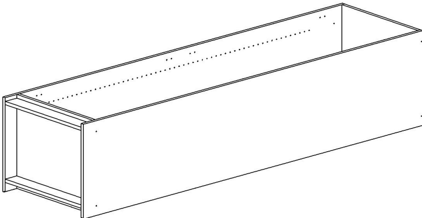
6. Перевернуть шкаф, вставить в четверть заднюю стенку и прикрепить ее гвоздями по периметру корпуса.
