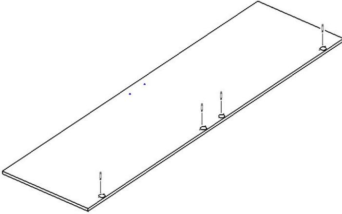
14. К боковине корпуса шкафа арт. 01.01.02 или арт. 01.01.03 прикрутить с помощью саморезов ответные планки петель
