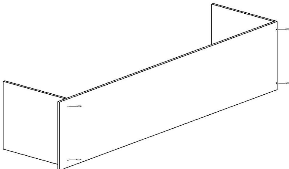
3. Установить две цокольные планки арт. 01,04,05. Первая планка: от переднего края стеллажа отмерить 20 мм, приставить цокольную планку и закрепить мебельными уголками изнутри с помощью саморезов. Вторая планка: от заднего края стеллажа отмерить 50 мм, приставить
