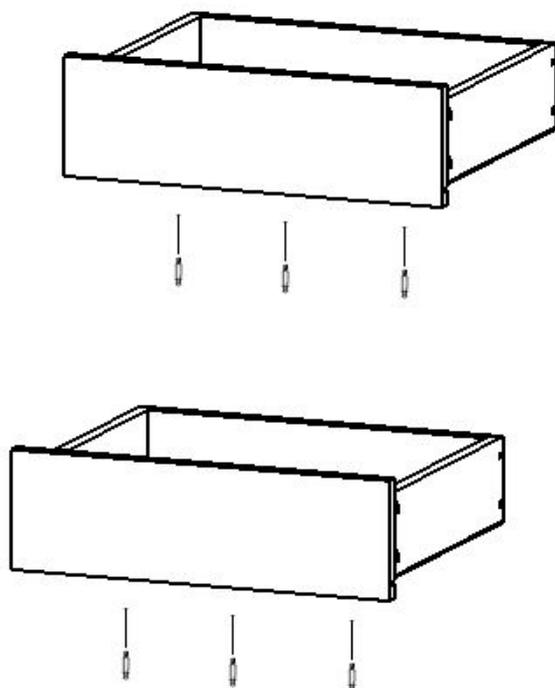
8. К деталям арт. 03.04.12 и арт. 03.03.13 прикрутить направляющие с помощью саморезов
