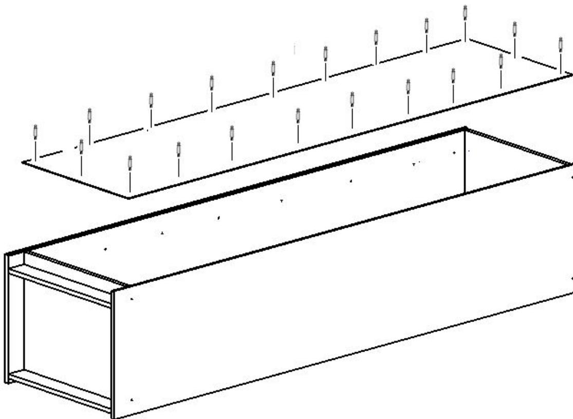
6. Вставить полкодержатели в отверстия боковых стенок стеллажа, установить на них полки
