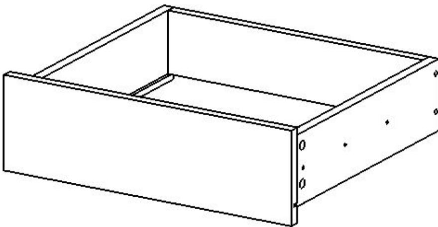
6. В пазы деталей арт. 03.03.05, арт. 03.03.02, арт. 03.03.04 вставить дно ящика (деталь арт. 03.03.01), зафиксировать гвоздями
