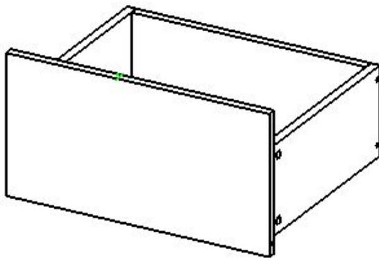
13. Установить в ящик дно (деталь арт. 03.04.14), вставить его в паз детали арт. 03.04.04, прибить гвоздями к детали арт. 03.04.06
