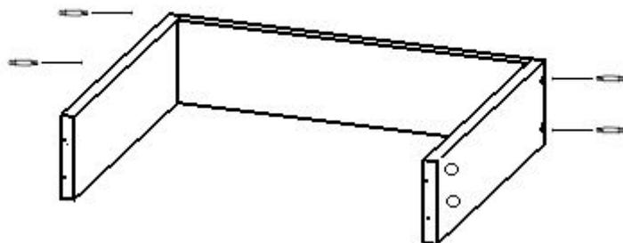
12. Присоединить деталь арт. 03.04.04, закрутить эксцентрики минификсов
