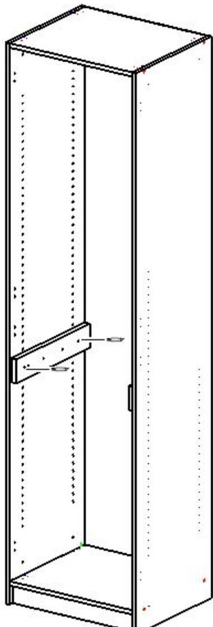
8. На детали арт. 03.03.06 установить направляющие с помощью шурупов
