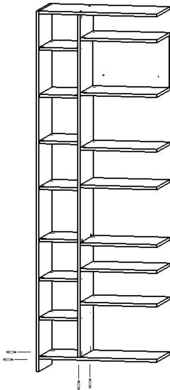
8. Установить детали арт. 14.06.05 - 2 шт., закрутить эксцентрики минификсов
