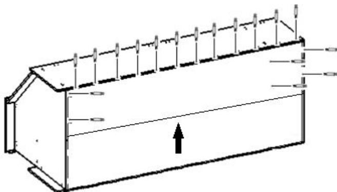
10. Деталь арт. 01.02.01 вставить в профиль соединительный, закрепить с помощью гвоздей, перевернуть шкаф
