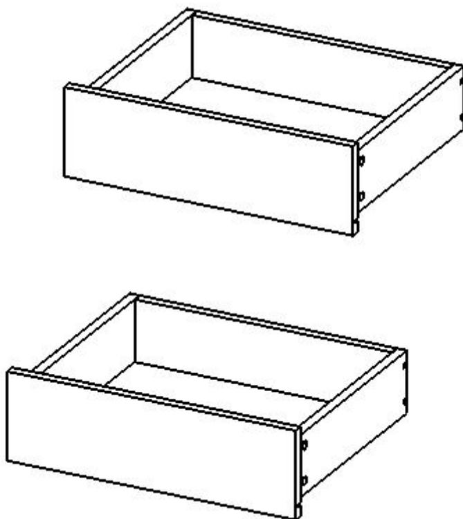
7. Установить в ящики дно (деталь арт. 03.04.14), вставить его в паз детали арт. 03.04.05, прибить гвоздями к детали арт. 03.04.09
