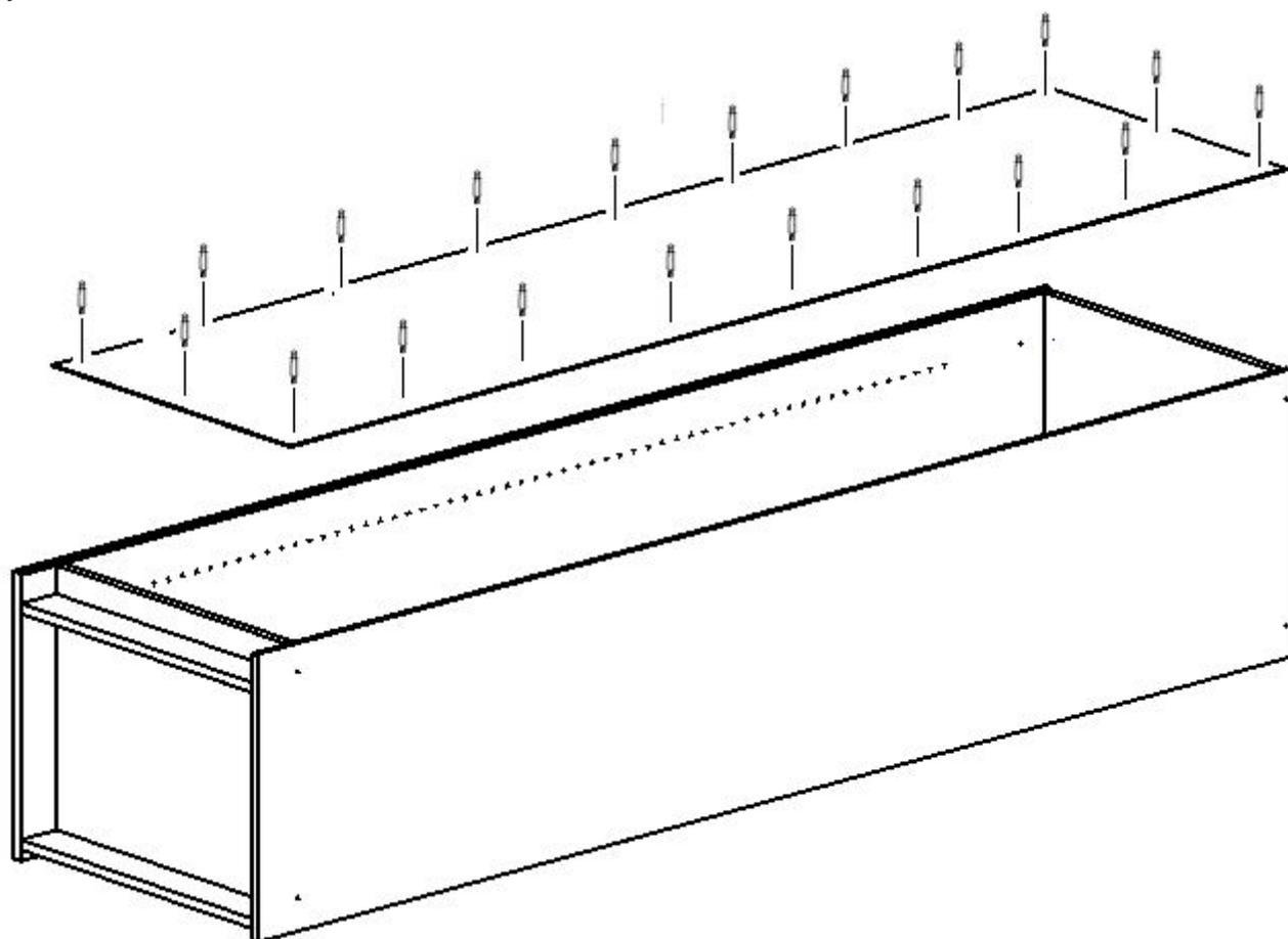
7. Прикрепить шкаф к стене с помощью винтов установочных
