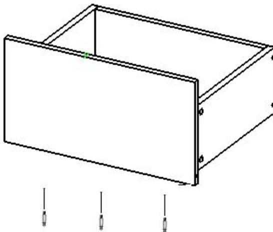
14. К деталям арт. 03.04.07 и арт. 03.03.08 прикрутить направляющие с помощью саморезов
